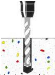
Seleccione una broca de carburo con un diámetro igual al diámetro del perno. Taladre a cualquier profundidad superior al empotramiento deseado.
